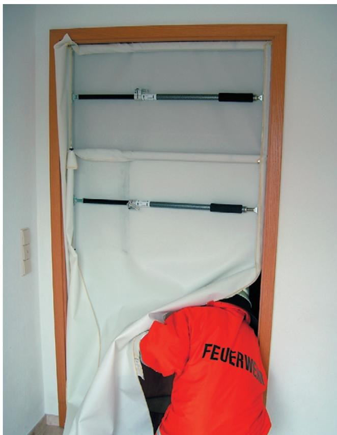
Wird der Rauchverschluss in der unteren Türhälfte eingebaut, wird der Rauchdurchgang auch bei sehr ungünstigen Bedingungen (z. B. starke Luftströmung/Wind) minimiert.
