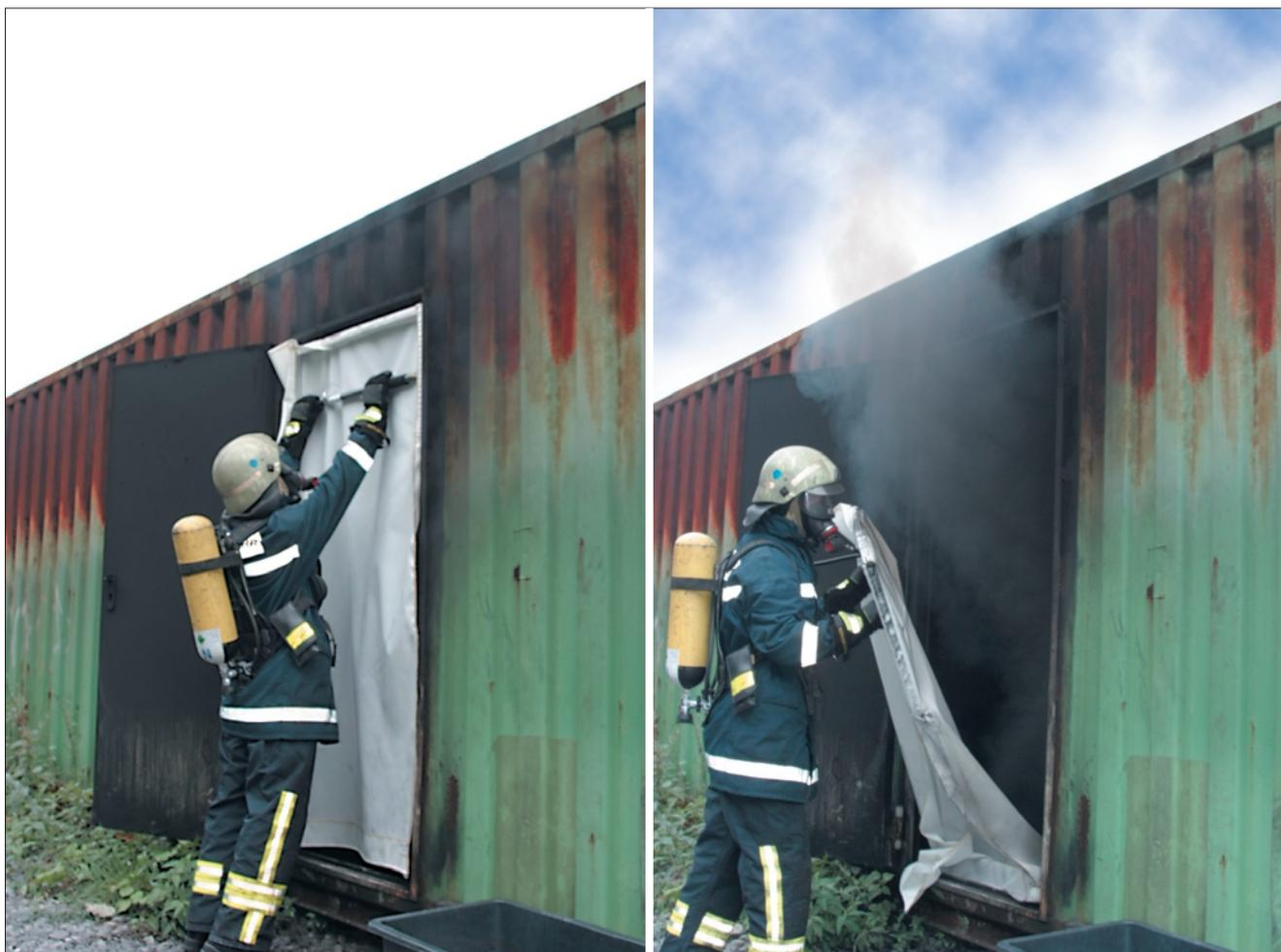
**links:** Vorführung des mobilen Rauchverschlusses an der holzbefeuerten Wärmegewöhnungsanlage des Kreises Mettmann: Bei eingebautem Rauchverschluss gibt es keine diffuse Rauchausbreitung.
